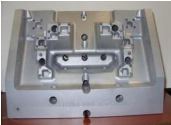
Expandeur aluminium anodisé (diamètre=240-300 mm)
