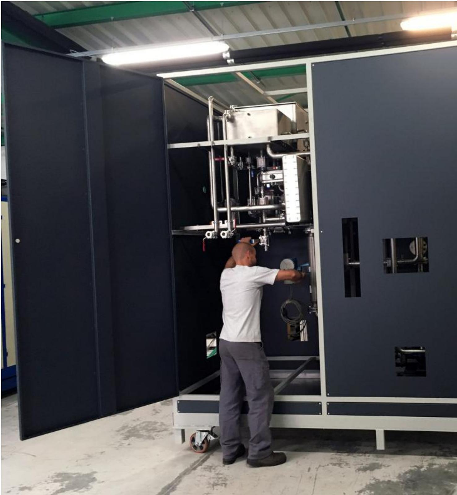
Notre nouveau banc PVT , équipement additionnel à ceux existants, réalise trois types de sollicitations : en pression cyclée, en vibration et en température dans une enceinte climatique. Il est dédié à tous les montages contraints des moteurs de véhicules comme les circuits de refroidissement, les durites ou encore les pompes. Ce banc, polyvalent, accepte des plages de tests très larges afin de correspondre aux cahiers des charges des principaux constructeurs automobiles.
