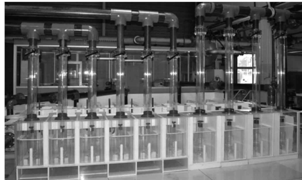
Modèle de la station de pompage au 1/13
